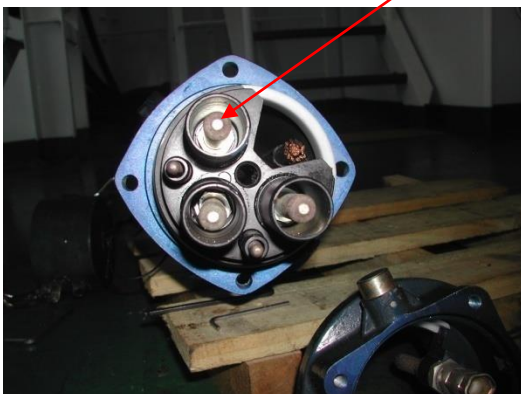
Male Plug 有 6 條線 (發現接地的線)
