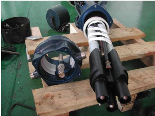
Male Plug 有 6 條線 (發現接地的線)
